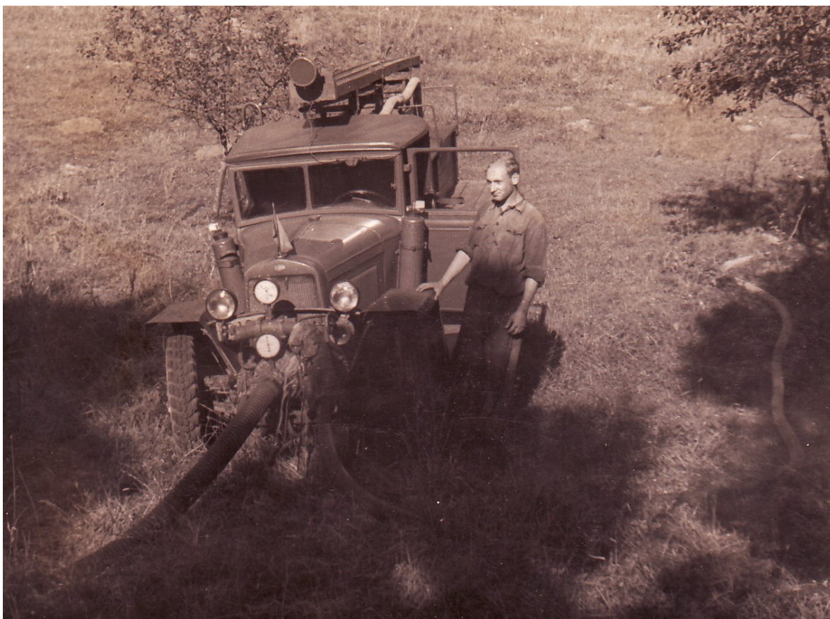
Tukuma PUK ugunsdzēsēju mašīna PMG-2 ar sūkni priekšpusē. (Fotogrāfija no Tukuma muzeja)
